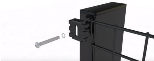
La [fixation](#) consiste en 1 pièce métallique, une rondelle et une vis à métaux. Répétez l'opération sur tous les points de fixation prévus en fonction de la hauteur.
