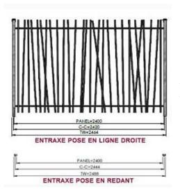
L'entraxe de pose des poteaux pourra varier en fonction de la pose et des pièces utilisées qui font de ce fait varier la distance.
