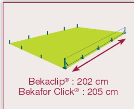
Enfoncer d'abord des piquets de référence (en bois par exemple) aux extrémités et aux angles de la clôture. Tendez une corde entre ces piquets en utilisant un niveau d'eau. Ceci vous permet de voir les dénivellations à combler ou à aplanir. Déterminez le long de la corde les emplacements où les poteaux doivent être installés. Tous les 202 cm, creusez un trou de 30 x 30 cm sur 50 cm de profondeur. (Attention, si votre pose se fait sur poteaux Bekafor Click l'entraxe de pose est différent)
