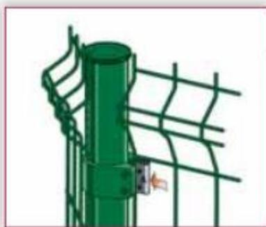
Une pièce spéciale de fixation spéciale, à insérer dans le collier, est nécessaire pour former les angles. Tous les angles sont possibles avec ce type de poteau.
