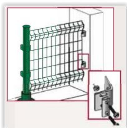
Des fixations en inox permettent d'attacher les panneaux sur un mur. Ces pièces vous évitent d'avoir à installer un poteau. Les vis de fixation du panneau sont fournies. N'oubliez pas d'acheter par ailleurs des vis de fixation adaptées au support mural.
